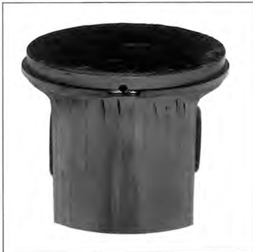
12., kép Szívóoldal. A dugattyú a gyűrű alatti részen kopott, karcos.
