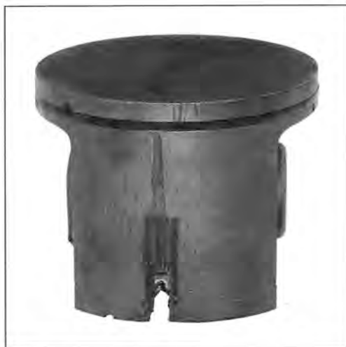
13., kép Szívóoldal. Dugattyúfelület erősen sérült.
