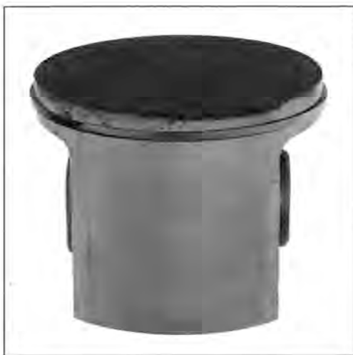
10., kép Szívóoldal. Finom bema- ródások, csiszolódások, mattszürke du- gattyúfelület.
